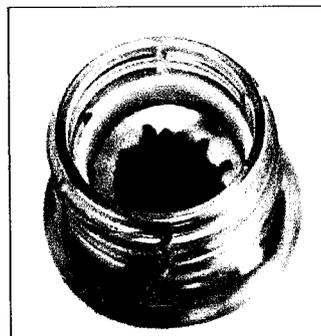
Abb. 7: Siebeinsatz mit körniger Aktivkohle in PET-Preform
